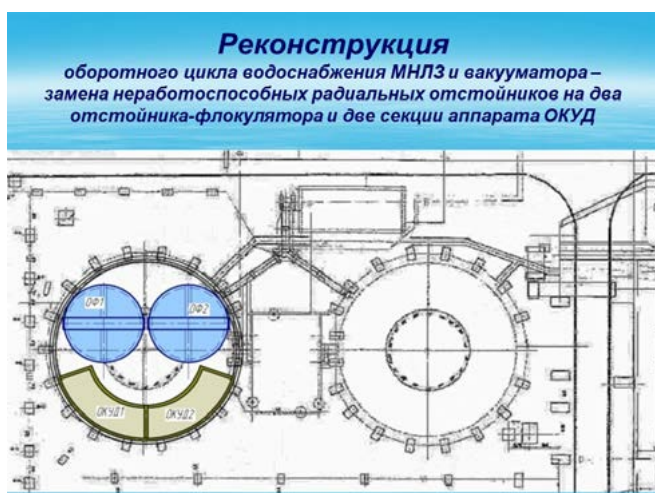
Рисунок 11. Реконструкция оборотного цикла сталеплавильного цеха металлургического комбината с заменой вышедших из строя радиальных отстойников диаметром 30 м и системы перекачки осадка в шламонакопитель на два аппарата «ОФ ЭП» и два аппарата «ОКУД».
