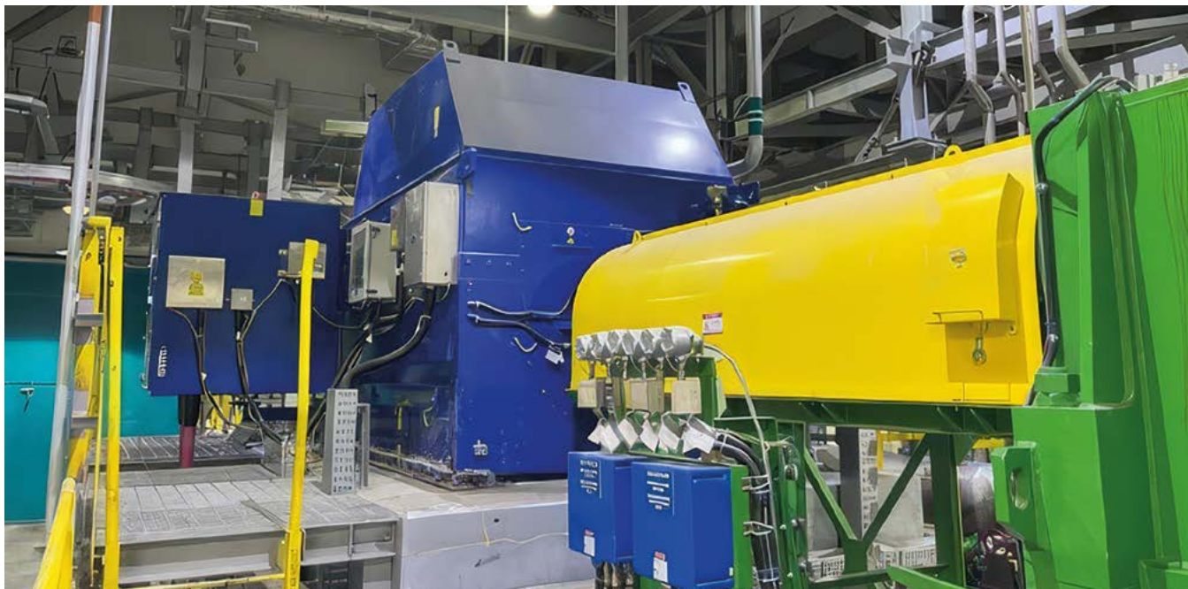
Рисунок 2. Экструдер с синхронным электродвигателем 14 МВт.
