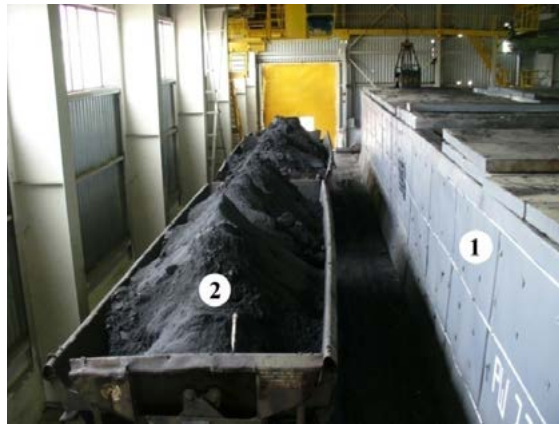
Рисунок 5. Оборотный цикл МНЛЗ. Аппарат «ОКУД» с совместно обезвоженными осадками: окалиномаслосодержащими и от установки умягчения подпиточной воды
